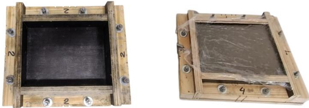
Figura 5.16 – Fôrma para concretagem dos prismas
