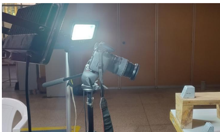
Figura 5.24 – Posicionamento da câmera para superfície inclinada
