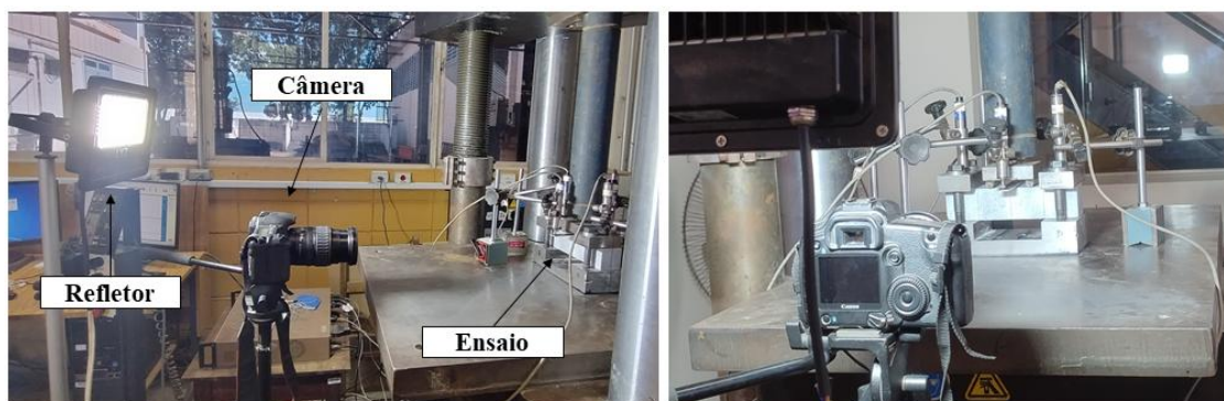
Figura 5.27 – Arranjo experimental para a aquisição de imagens
