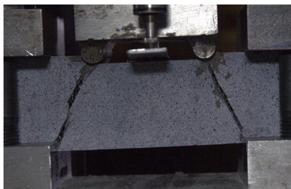
Figura 5.12 – Padrão de ruptura por cisalhamento observado no corpo de prova
