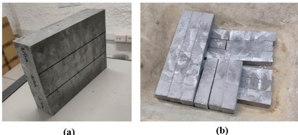
Figura 5.22 – (a) Peça concretada; (b) prismas obtidos através do corte das peças
