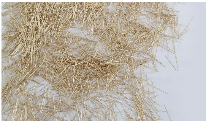
Figura 4.5 – Fibras de aço lisas e curtas geralmente utilizadas no UHPFRC
