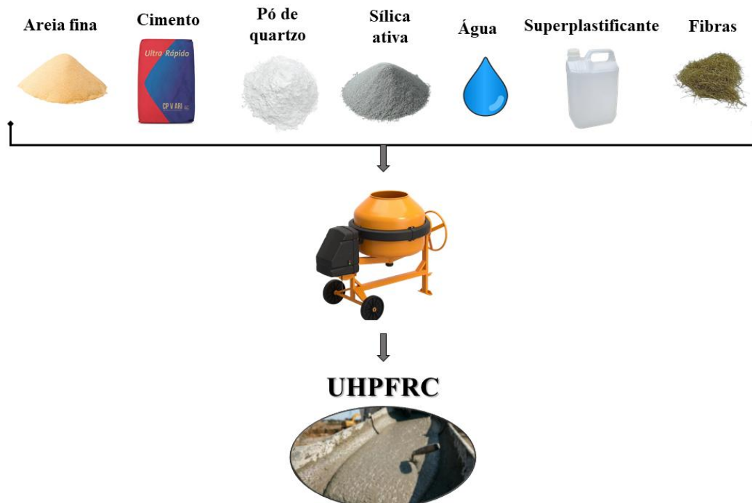
Figura 4.2 – Composição básica do UHPFRC
